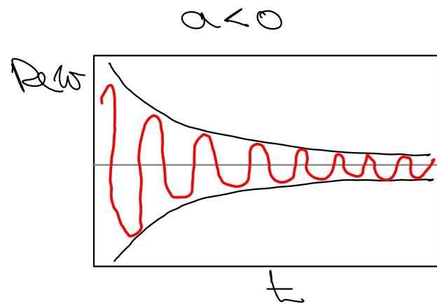
Entsprechend stellt auch der Imaginärteil  $\Im(w(t))$  eine gedämpfte bzw. angefachte Schwingung dar.
